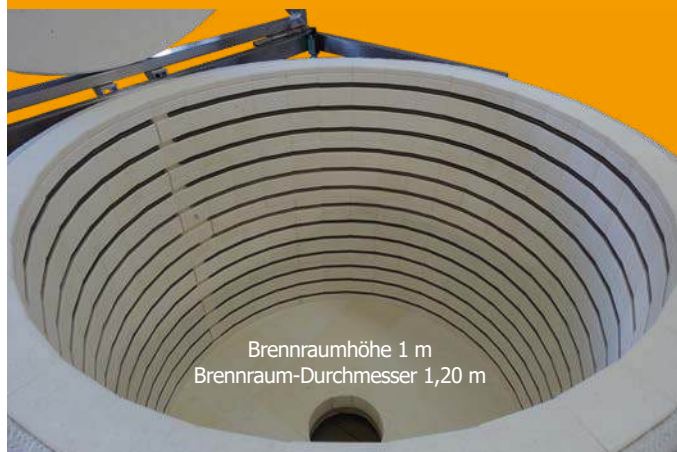
Extrem großer Topflader zum Glasschmelzen in einem speziellen Tiegel bei 1.350 °C.
