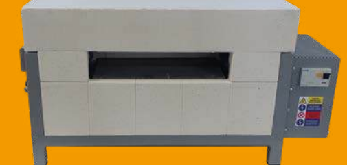
Offener High-Speed-Spezialofen mit abnehmbarer Decke.
